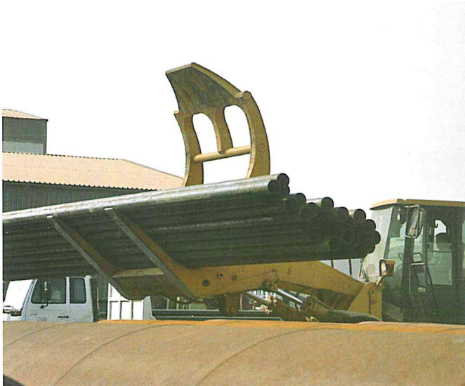
عملية تحميل وتنزيل الأنابيب قبل التغليف
